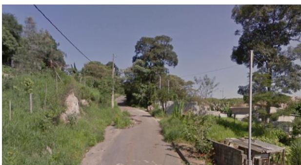
FIGURA 01: Rua Amélia Cota: via com pavimentação asfáltica e ausência de meio fio e calçadas delimitadas.
